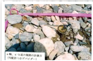
1個ずつ丁寧に礫の最大投影面の傾きを計測します。写真中の機器は自作です。
