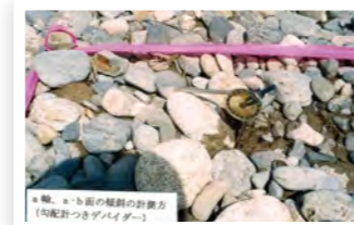
1個ずつ丁寧に礫の最大投影面の傾きを計測します。写真中の機器は自作です。
