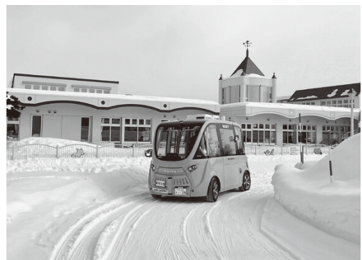
図13 東川町内を走行する自動運転バスの試運転状況
